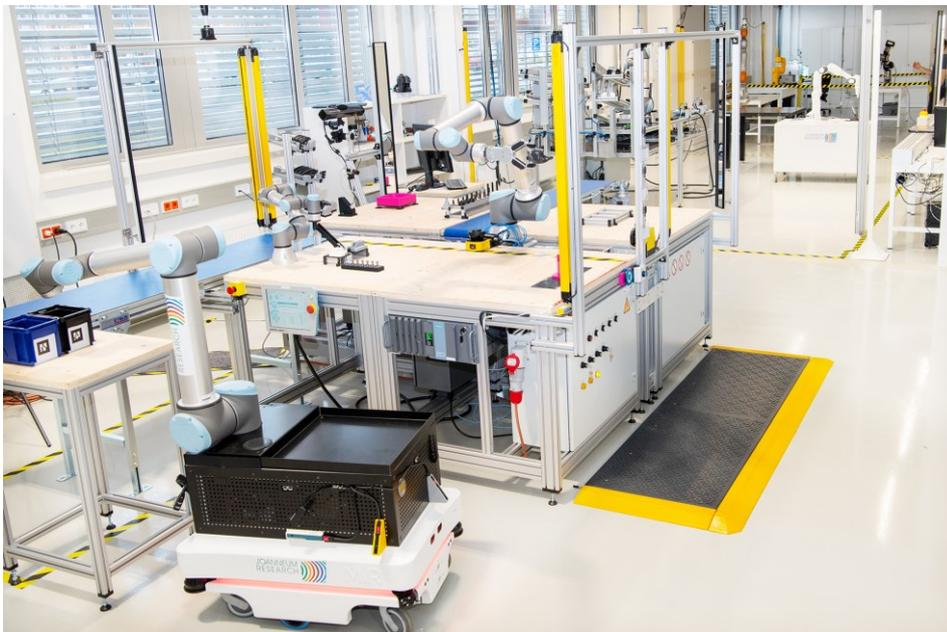
Abbildung A1: Klassische Sicherheitseinrichtungen ("gelbe" Hardware) sind meist bauliche, stationäre Einrichtungen. Sie reagieren auf Annäherung (mittels Laser), Druck oder auf Unterbrechung elektrischer Kontakte oder Lichtschranken. Mobile Roboter tragen diese mit sich.
